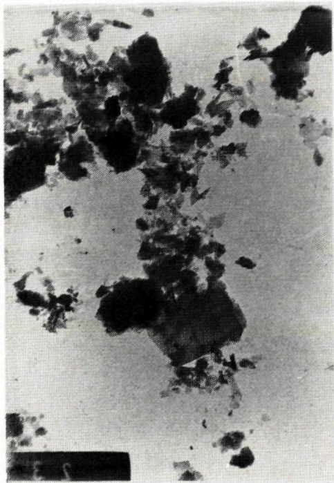
Obr. 5. Snímka amónnej hydrosľudy elektrónovým mikroskopom. Zväčš. 6000×.
